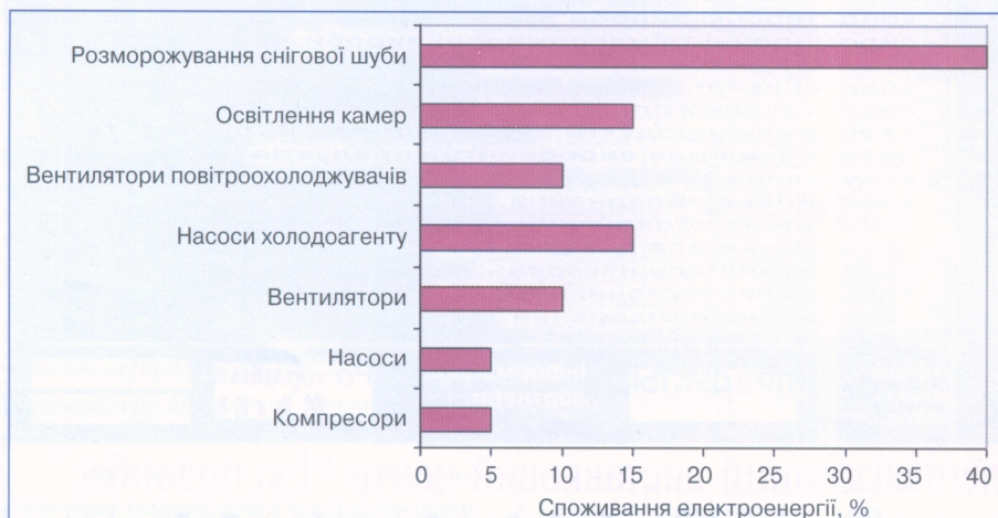
Рис. 3. Нераціональне споживання електроенергії елементами АХУ типового м'ясокомбінату продуктивністю 100 тонн за зміну
