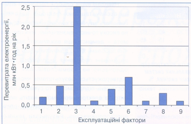
Рис. 2. Можливі перевитрати електроенергії (5,0÷8,0 млн кВт·год/рік) для типового м'ясокомбінату продуктивністю 100 т/зміну від таких факторів: 1 – снігова шуба; 2 – мастило в системі; 3 – повітря в системі; 4 – недостатнє заповнення системи холодоагентом; 5 – підтоплення чи недостатнє зрошення конденсаторів; 6 – накип на теплообмінній поверхні конденсаторів; 7 – порушення теплоізоляції трубопроводів; 8 – порушення теплоізоляції огорожувальних конструкцій; 9 – інфільтрація теплового повітря через дверні прорізи
