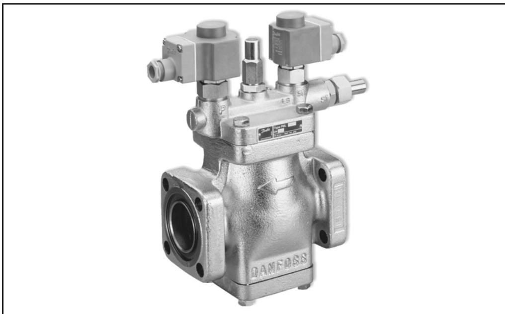
Вентили PML представляют собой сервоуправляемые вентили с винченными управляющими электромагнитными клапанами. Для открытия вентилей PML используют внешний источник давления, а это означает, что для поддержания вентилей в открытом состоянии не требуется наличие перепада давлений на нем. Благодаря этому вентиль особенно удобно использовать для всасывающих трубопроводов низкого давления.
