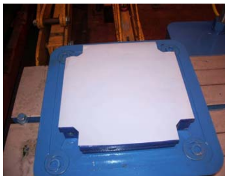
Рисунок 2а: Лист PTFE на нижней крышке
