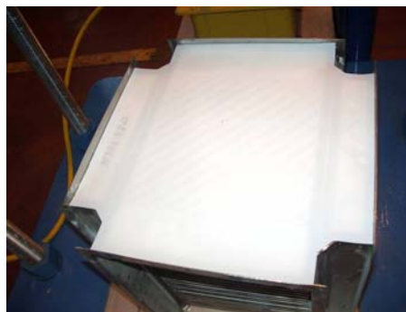
Рисунок 2б: Лист PTFE на верхней крышке
